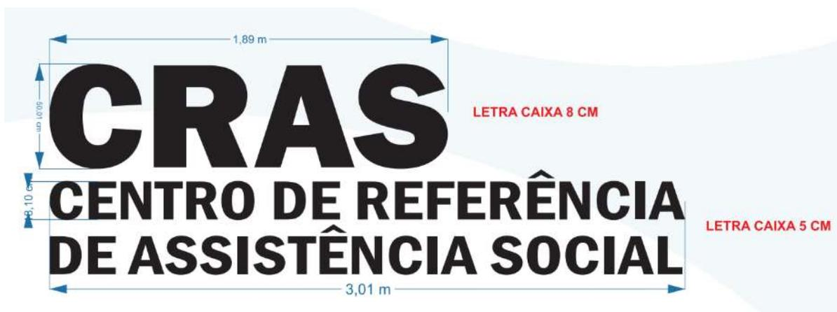
As letras serão fixadas com parafusos de aço tipo chumbador parabol, diâmetro 1/2", comprimento 75 mm
