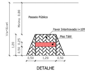
Detalhe em corte da execução do piso tátil em passeios existentes
