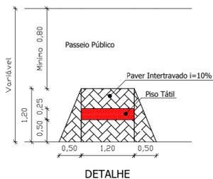
**Detalhe em corte da execução do piso tátil em passeios existentes**
